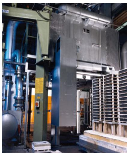
圖 7 鐘罩式窯爐
