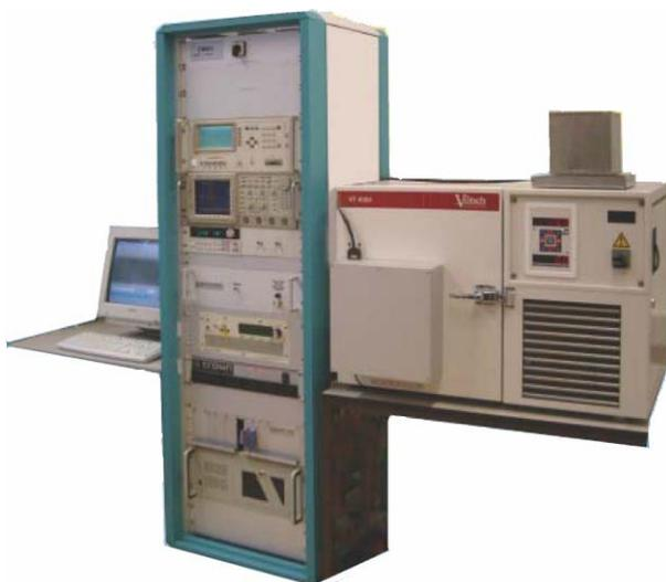
量測動作的執行是由軟體程式控制，經由電腦輸入量測項目與條件後，電腦即會給出指令讓訊號產生器提供所需訊號源，再依量測時所需訊號之大小經由放大器做高低頻切換與電壓訊號放大等程序後將正確訊號提供給待測物，再由示波器取得此時的電壓、電流與相位差等數值轉由電腦進行數據處理並得到測試結果。
